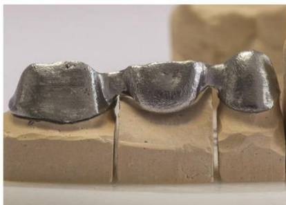
فریم های تولید شده به روش ذوب با سرشالومه و سانتیفیوژ ( بعد از اصلاح سطوح داخلی)
