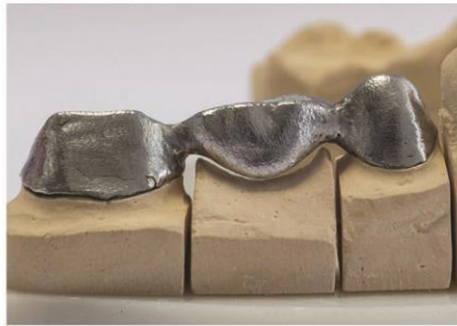
فریم های تولید شده به روش ذوب با سرشالومه و سانتیفیوژ ( بعد از اصلاح سطوح داخلی)
