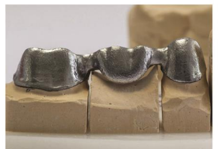
فریم های تولید شده به روش ذوب با سرشالومه و سانتیفیوژ ( بعد از اصلاح سطوح داخلی)
